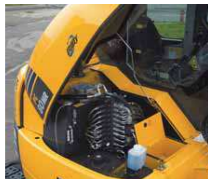
Capota laterala pentru acces rapid la supapa principala de control, pentru alimentarea rezervorului de combustibil, al celui de ulei sau trusa de unelte
