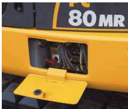
Batteriets huvudbrytare är standard.
