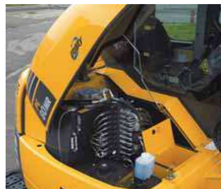
Deksel på høyre side som sikrer enkel tilgang for hovedkontroll av ventiler, diseltank, olje tank og verktøyskrin
