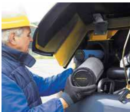
Deksel bak som sikrer enkel og rask tilgang for motorsjekk samt enkel og rask tilgang til servicepunktene fra bakkenivå
