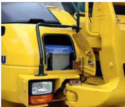
Accesso alle batterie da terra
