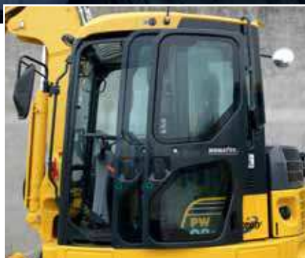
Posuvné dveře kabiny usnadňující nastupování a vystupování
