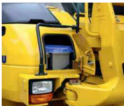
Přístup k akumulátoru z úrovně terénu
