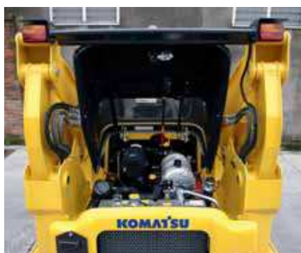
Kryt motoru: rychlá kontrola motoru
