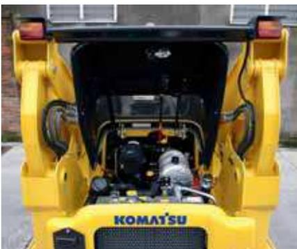
Capot: contrôle rapide des éléments du moteur
