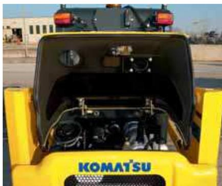
Capot: contrôle rapide des éléments du moteur
