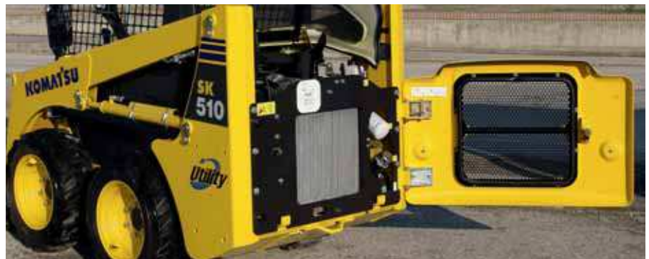
Capó trasero: inspección y limpieza simples de los radiadores
