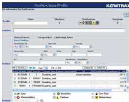
Benachrichtigungsfunktion – Warnhinweise der Maschine können über die KOMTRAX™-Internetseite eingesehen oder per E-Mail empfangen werden.
