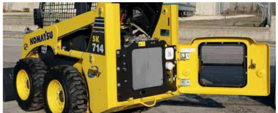
Die große Heckklappe erleichtert Inspektion und Reinigung des Kühlers.
