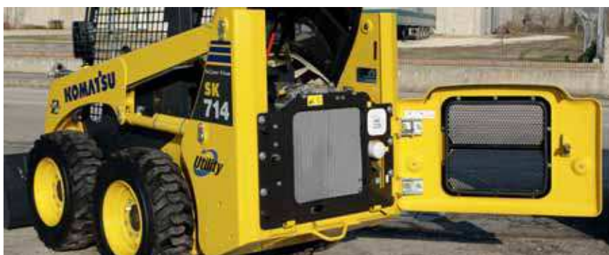
Il portellone: semplice ispezione e pulizia dei radiatori
