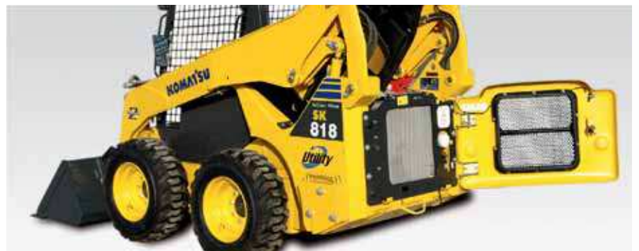
Hayon arrière: inspection et nettoyage aisés des radiateurs
