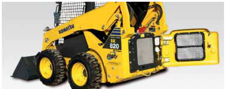
A escotilha traseira: inspeção simples e limpeza dos radiadores
