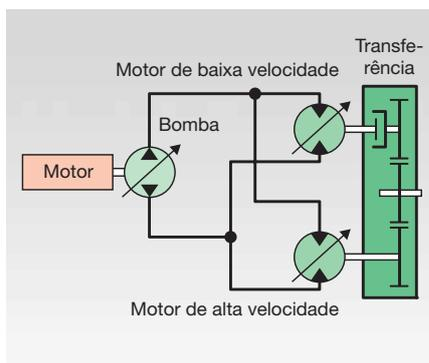
Transmissão hidrostática (HST) controlada eletronicamente
