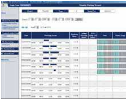
Maskinens arbeidstid – Med “daglig driftsjournal” diagram, vil du få eksakte motor data: når din maskin startet opp og når den stoppet, samt den totale tiden maskinen har vært i drift.
