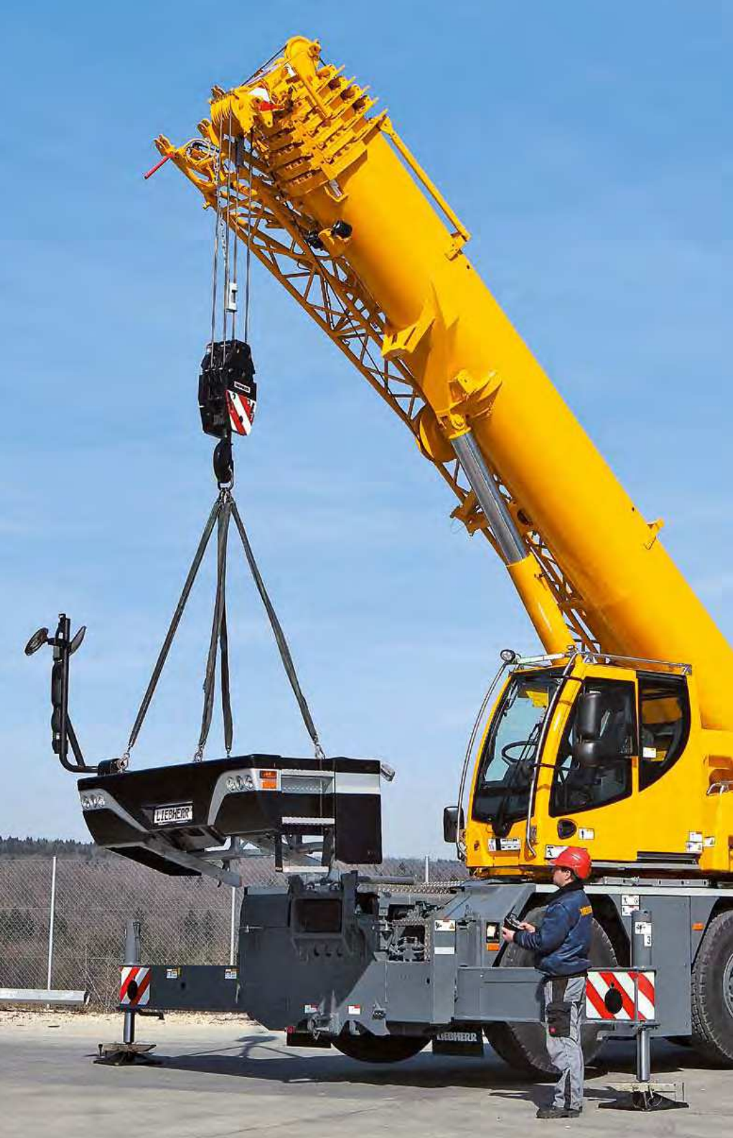
Einfacher und schneller Abbau des vorderen Staukastens
