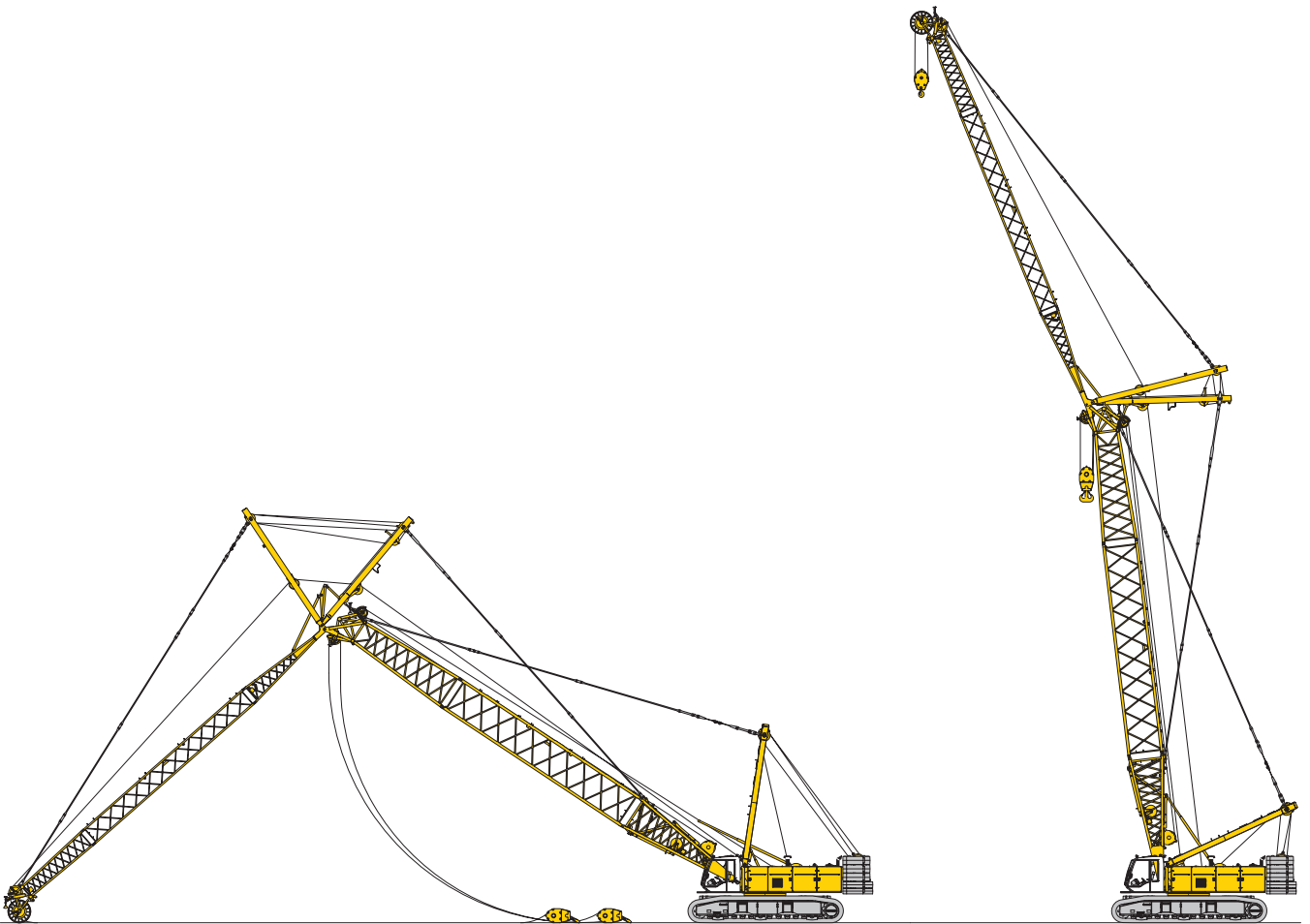
Elevación de la pluma principal y del plumín abatible
