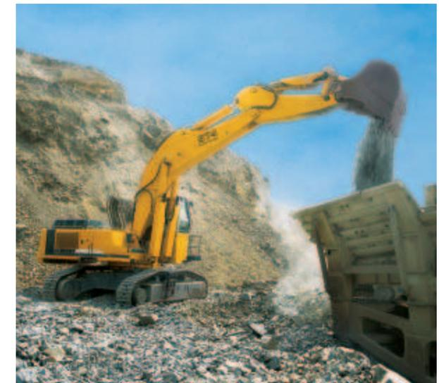
Für das Umsetzen auf ein neues Haufwerk legt der R 974 B SME Litronic zuerst eine Auffahrrampe an und richtet dann den Anfangstandplatz auf dem Haufwerk her. Parallel dazu wird über die selbstfahrende Vorbrecheinheit das nachgeschaltete Bandsystem nachgezogen und positioniert.
