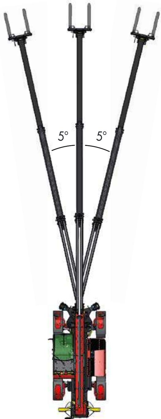
Este telescópico está equipado com translação lateral que permite o movimento lateral da parte traseira do chassis e, com isso, do braço telescópico em relação ao eixo longitudinal da máquina para corrigir a posição de carga sem necessidade de deslocar o veículo. Este sistema permite uma translação de +/- 5° que corresponde a uma deslocação de +/- 1,5 m com o braço completamente estendido, independentemente do acessório equipado
