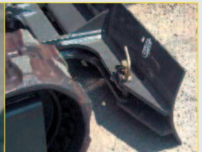
Sofort einsatzbereit: Ein einfach oder doppelt wirkender Hydraulikkreislauf für Anbaugeräte mit Anschlüssen am Löffelstiel als Standard.
