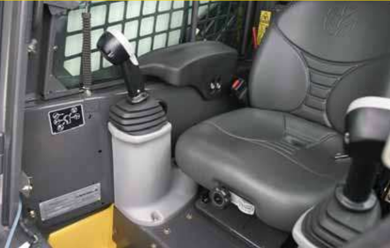
Los apoyabrazos ajustables y el asiento con suspensión le permiten al operador encontrar una posición de trabajo cómoda
