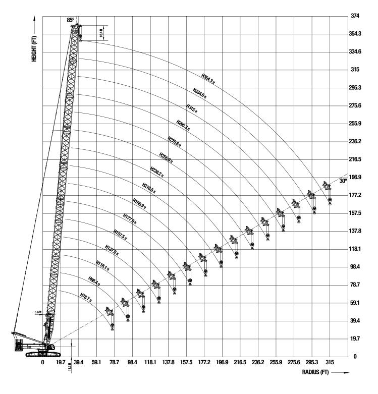
\*\*THIS GRAPHIC REPRESENTATION IS ONLY A GUIDE AND SHOULD NOT BE USED TO OPERATE THE CRANE.
