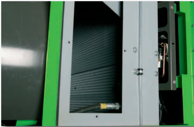
Eine Kühlbox mit 3-Kreis-Kühlsystem für Ladeluft-, Wasser- und Ölkühlung
