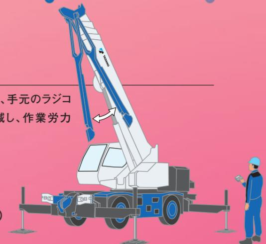
※セットアップラジコンでのクレーン操作は、アウトリガの張出・格納、フックイン、フックの交換、ジブの装着・格納のみに使用してください。クレーン作業には使用できません。
