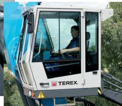
Interno ben organizzato progettato in modo ergonomico. Aiutato dal display a colori e dalla consolle, l'operatore può facilmente controllare tutte le funzioni principali seduto comodamente all'interno della cabina insonorizzata.
