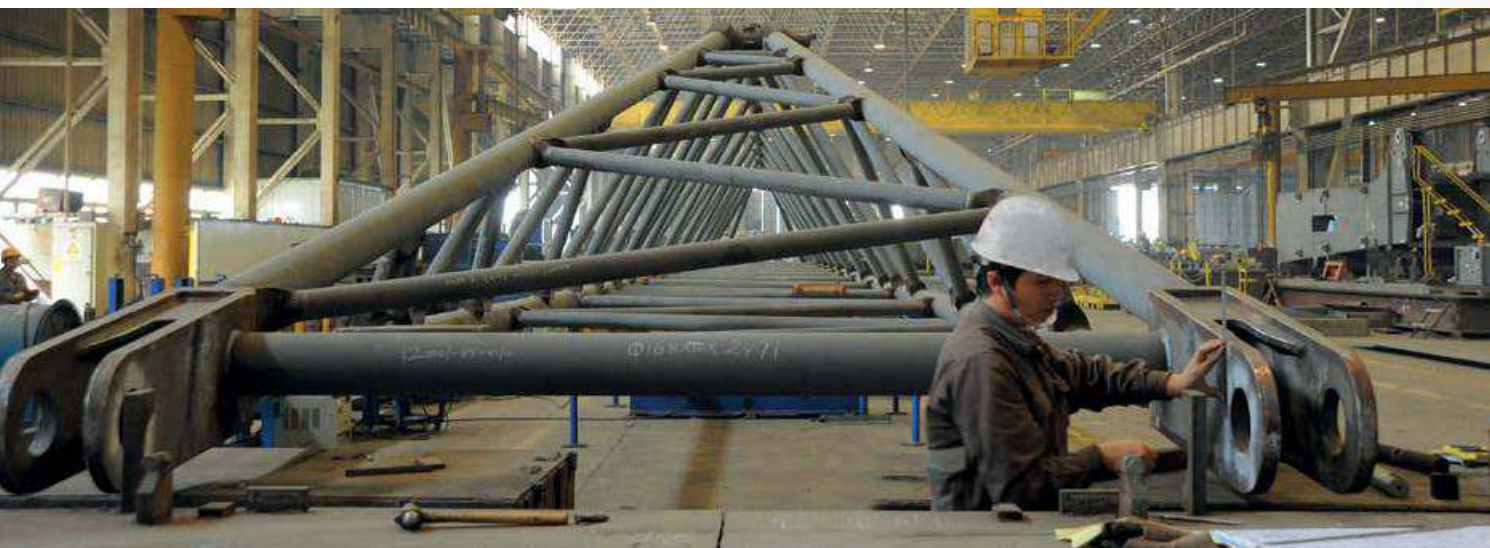
中国厦门制造的Quaymate M50 移动式港口起重机格型臂架
