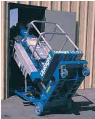
Gracias al sistema de inclinación esta permitido el paso a través de puertas. El amplio diámetro de las ruedas traseras se mueve fácilmente por encima de los dinteles.
