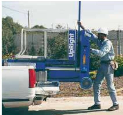
Todos los modelos de UL equipados con el cargador EZ para ayudar a cargarlos en camiones transportadores.
