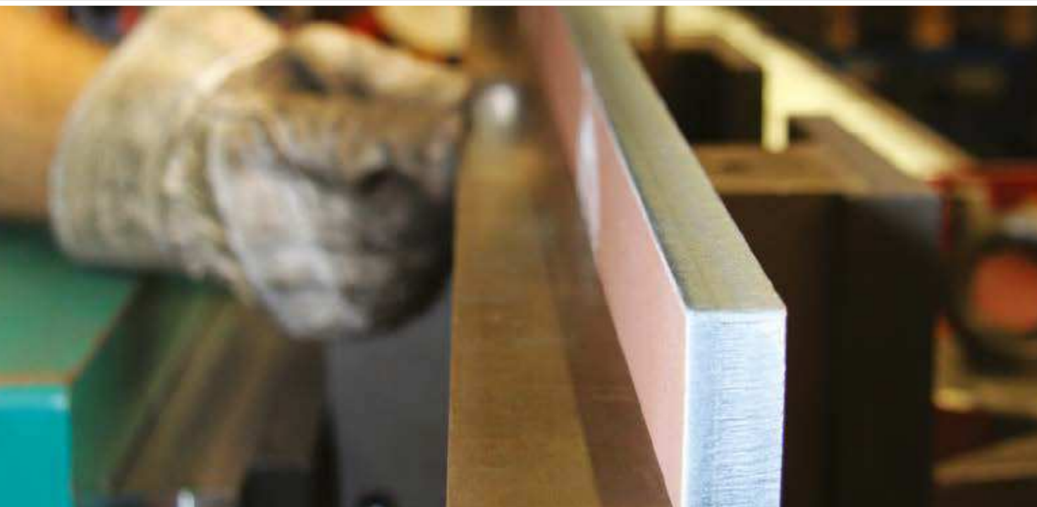
Das spannungsfreie Richten mit einer Ebenheitsabweichung von max. 2/10 mm sorgt für eine hohe Lebensdauer des Glättblechs durch gleichmäßigen Verschleiß.
