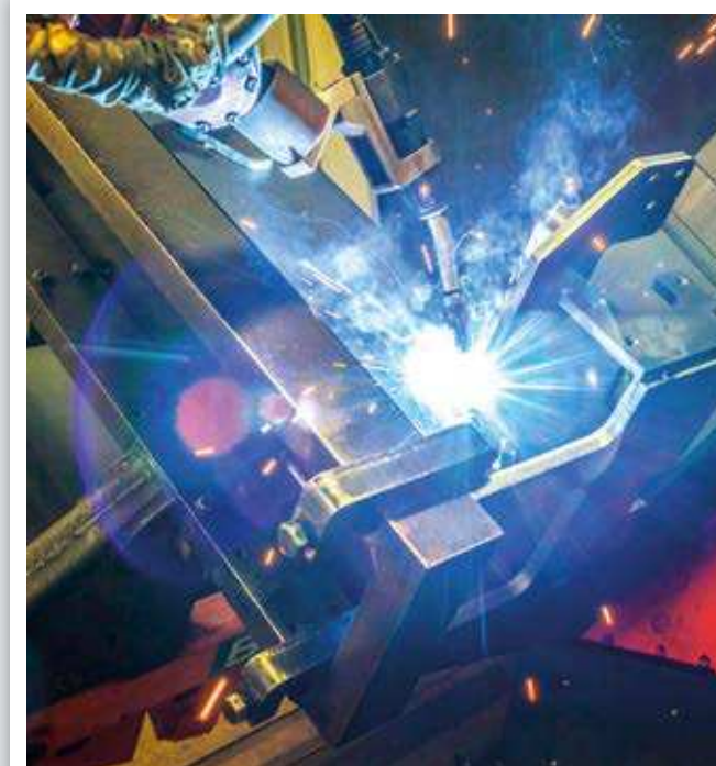
Robotergesteuertes Schweißen der Glätterahmen und Aufhängungsgruppen garantiert eine gleichbleibende Präzision und Qualität der Schweißarbeiten.
