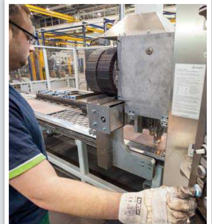
CNC-gesteuertes Aufschießen der Gewindebolzen.
