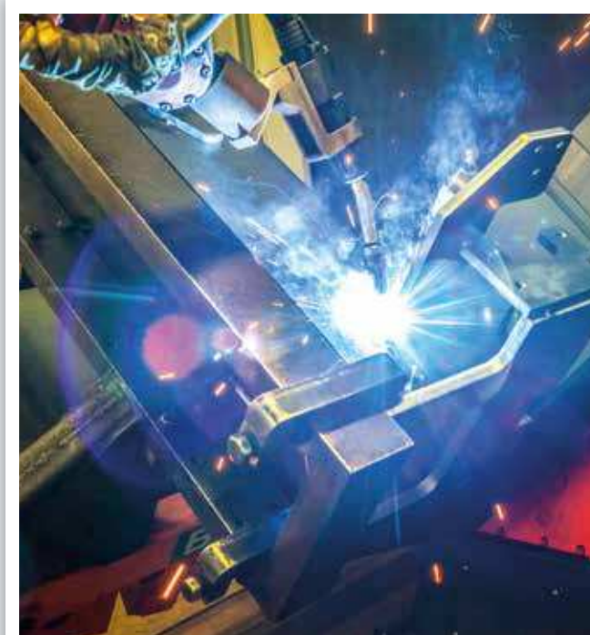
Le soudage par robots des châssis de table garantit une précision et une qualité constantes dans les travaux de soudage.
