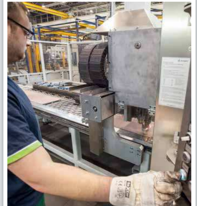
Soudure des goujons par commande CNC.
