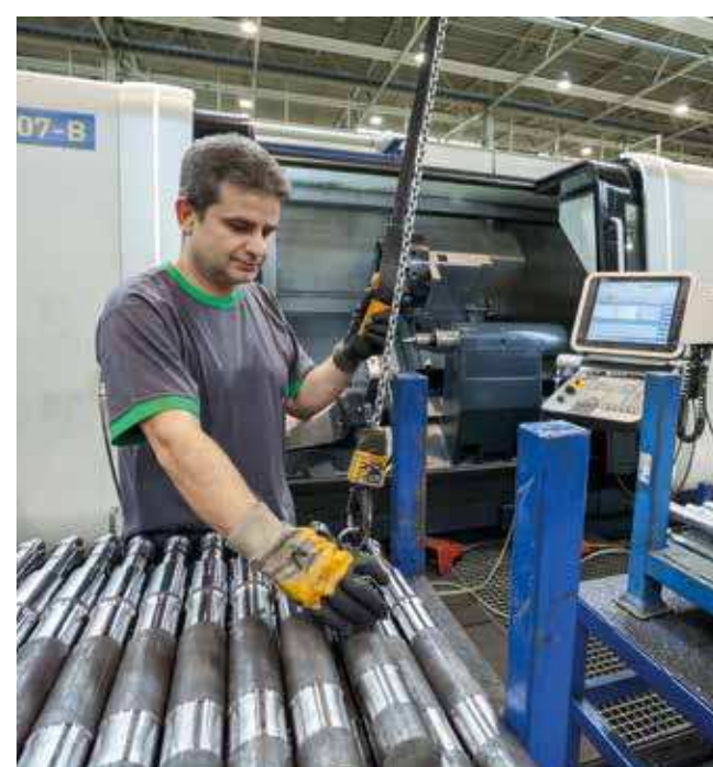
Arbres excentriques pour l'entraînement des dameurs.
