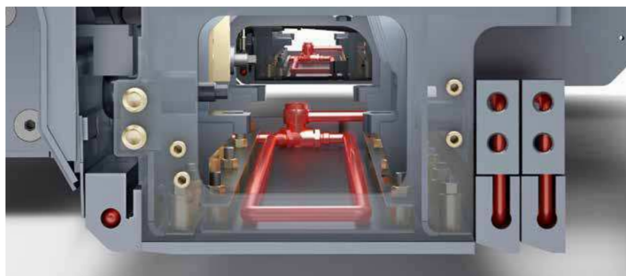
Tous les groupes de compactage sont chauffés sur toute la largeur de la table.
