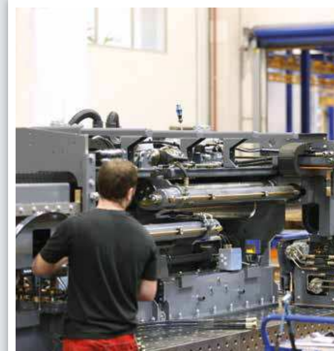
Assemblage final des tables : c'est à ce poste de travail que les tables VÖGELE sont complétées, et soumises à divers contrôles de fonctionnement.
