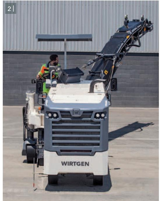
1 | - 2 | Универсальность достигается за счет больших углов поворота конвейера.
