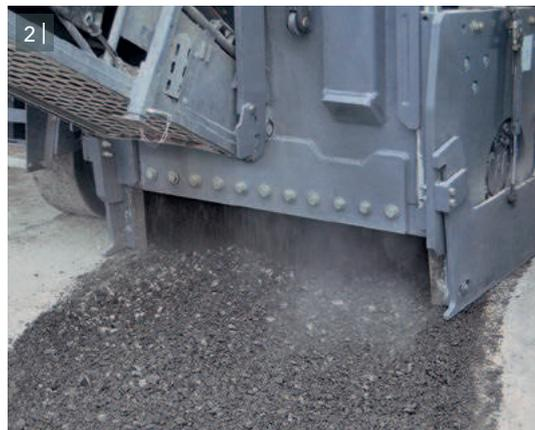
3 | - 4 | В крайнем нижнем положении нижняя часть бокового щита (также с системой гидравлической регулировки по высоте) надежно защищает фрезерную камеру, а в верхнем положении позволяет машине свободно перемещаться вдоль различных препятствий.
