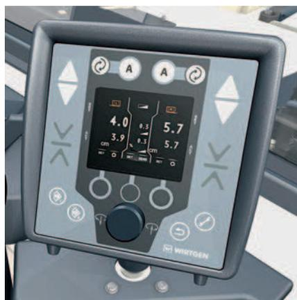
Le système de nivellement automatique LEVEL PRO PLUS.
