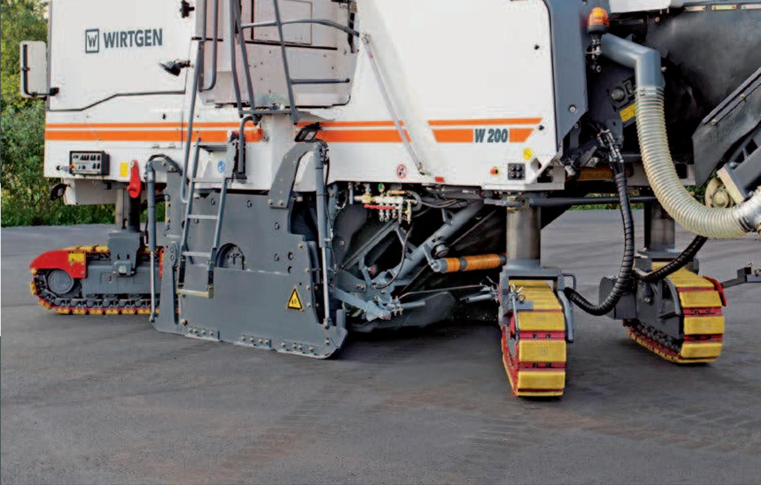
*Avec une largeur de travail de 2,0 m, il est possible de réaliser un rayon intérieur de 2150 mm.*
