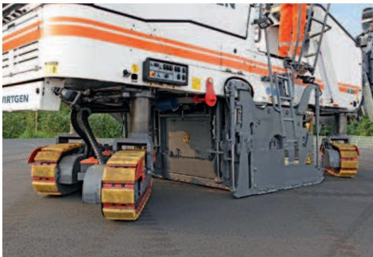
Il faut également mentionner le système intelligent de régulation de l'entraînement de translation ISC (Intelligent Speed Control) et ses trois fonctions principales : le système électronique antipatinage pour une traction optimale, l'adaptation automatique de la vitesse des différents trains de roulement dans les virages pour une usure réduite des patins, et l'optimisation de la puissance de traction permettant de rester dans la plage optimale de charge du moteur.
