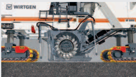
1 | La scarificatrice in assetto di trasporto
