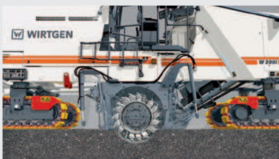
3 | A fresadora a frio se abaixa lentamente e permanece alinhada paralelamente
