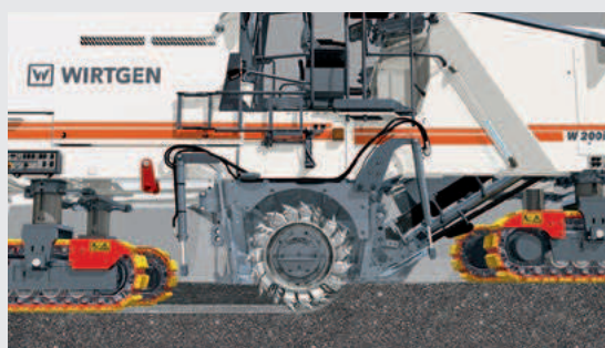
4 | A fresadora a frio realiza a fresagem com profundidade de trabalho total desde o primeiro metro
