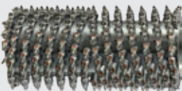
Tambor de fresado fino Anchura de fresado: 2.000 mm Profundidad de fresado: 0-100 mm Distancia entre líneas: 8 mm
