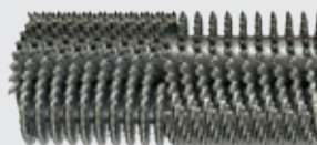
Tambor de fresado finísimo Anchura de fresado: 2.200 mm Profundidad de fresado: 0-30 mm Distancia entre líneas: 6 x 2 mm
