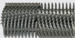
Tambor de fresado finísimo Anchura de fresado: 2.000 mm Profundidad de fresado: 0-30 mm Distancia entre líneas: 6 x 2 mm
