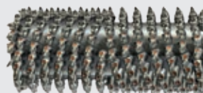
Tambor de fresado fino Anchura de fresado: 2.200 mm Profundidad de fresado: 0-100 mm Distancia entre líneas: 8 mm
