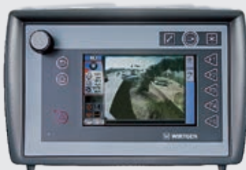
2 | Cámara dispuesta en el extremo de la cinta de carga
