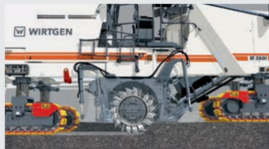
4 | La fresadora en frío fresa en toda la profundidad de trabajo, desde el primer metro
