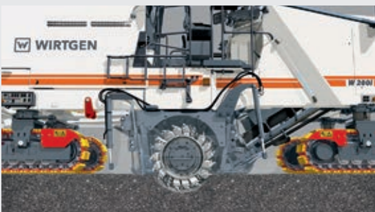
3 | La fresadora en frío desciende lentamente, permaneciendo siempre paralela al suelo
