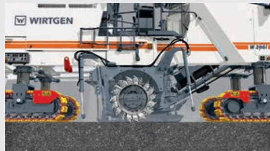
2 | La fresadora en frío desciende rápidamente, permaneciendo siempre paralela al suelo
