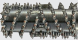
Tambor de fresado estándar Anchura de fresado: 2.000 mm Profundidad de fresado: 0-330 mm Distancia entre líneas: 15 mm
