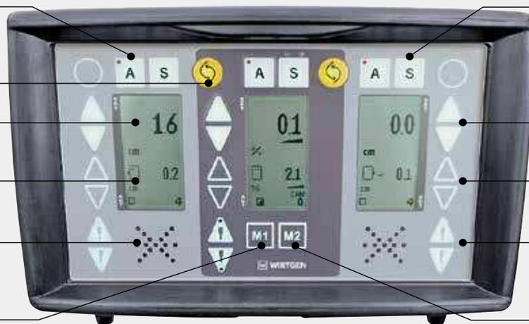
1 | 选配的电子横坡传感器用于铣刨出规定的横坡。
