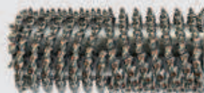
Feinfräswalze Fräsbreite: 2.000 mm Frästiefe: 0 – 100 mm Linienabstand: 8 mm
