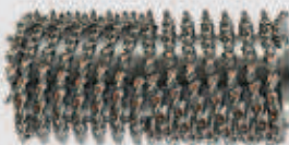
Feinfräswalze Fräsbreite: 2.000 mm Frästiefe: 0 – 100 mm Linienabstand: 8 mm
