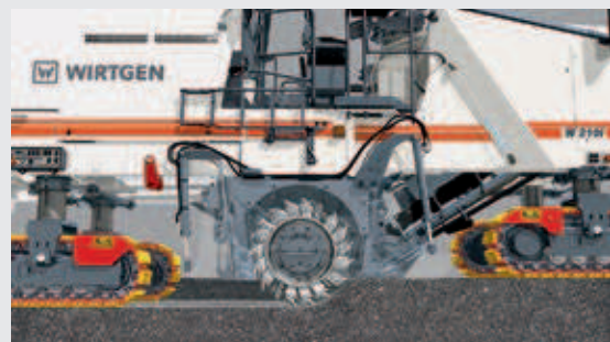
4 | Kaltfräse fräst mit voller Arbeitstiefe vom ersten Meter an
