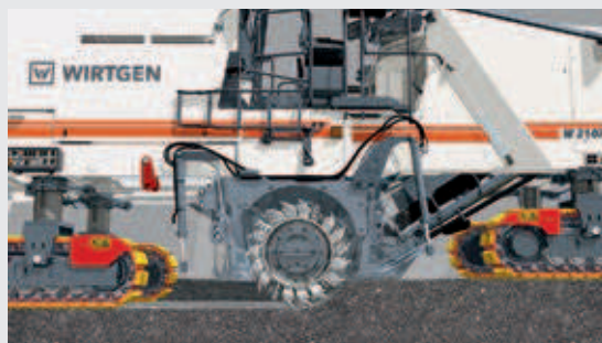
4 | La scarificatrice fresa sin dal primo metro alla piena profondità operativa
