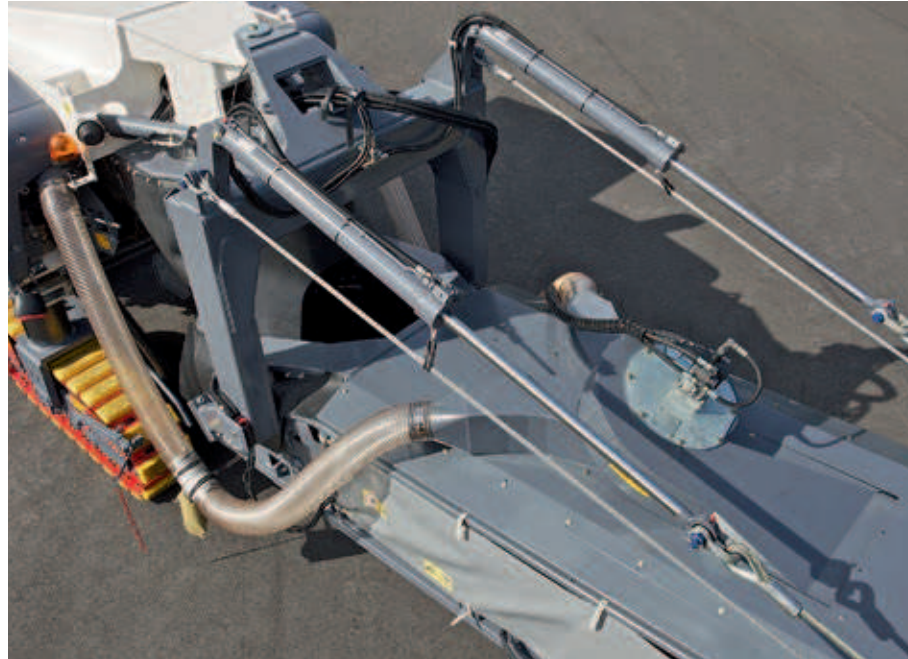
La vitesse de rotation du ventilateur radial est réglable.
